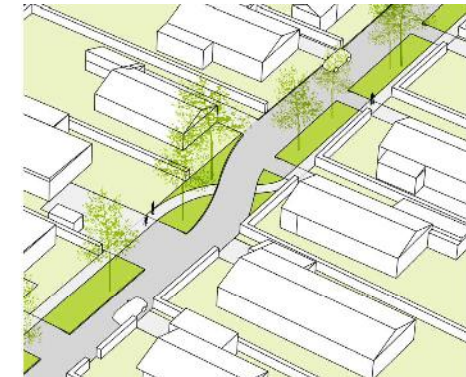
FORSÆTNING, REDUKTION AF HASTIGHED,
